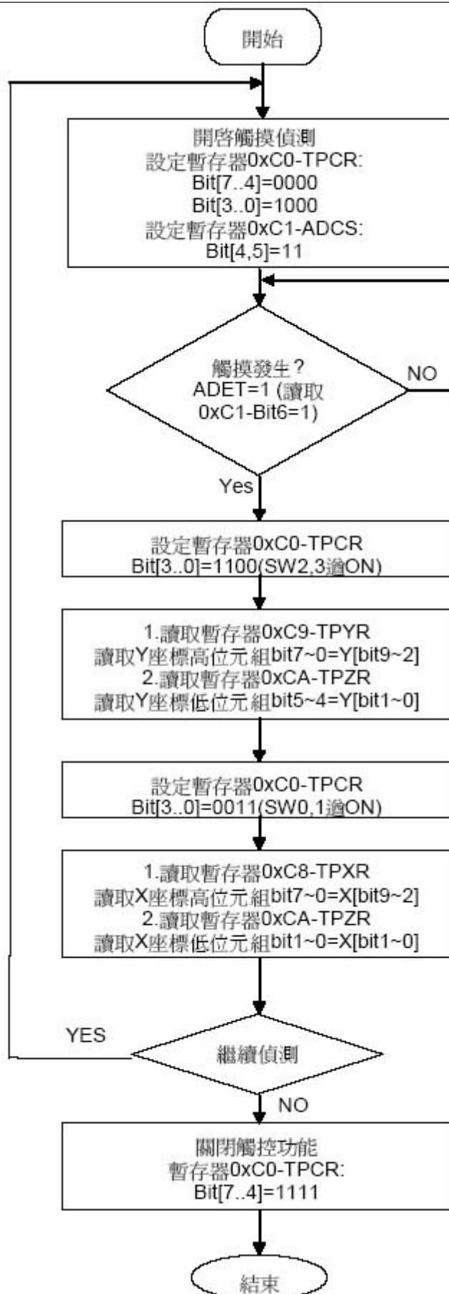
图 6-9: 触摸式面板读取的控制流程图
