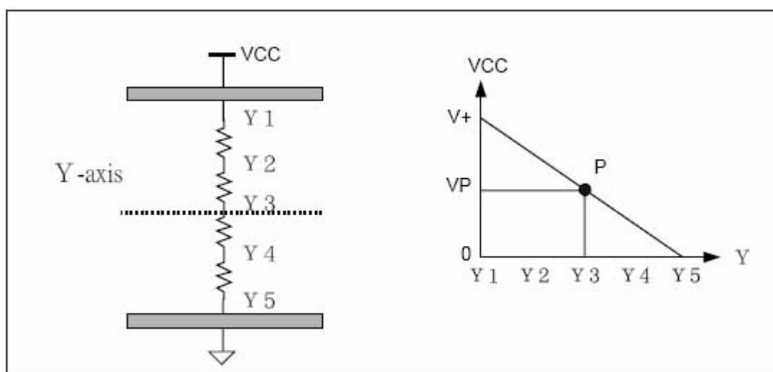
图 6-6: Resistor-Y 的分压
