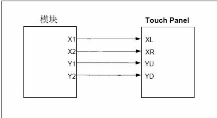
图 6-7: 触摸式面板应用电路
