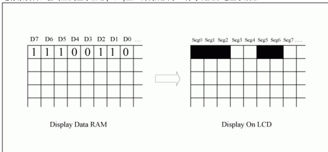
图 5-4: Display Data 到 LCD 显示的映射
