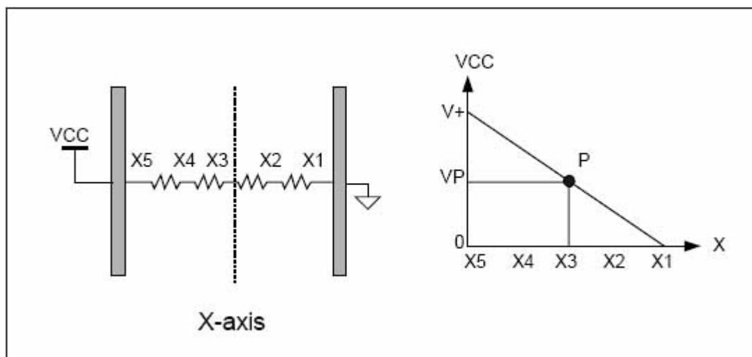
图 6-4: Resistor-X 的分压
